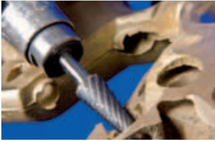
Rundkegelförmiger Frässtift mit runder Kuppe nach DIN 8032.
