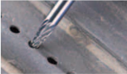
Spitzkegelförmiger Frässtift nach DIN 8032 mit Verzahnung nach DIN 8033, Spitze abgeflacht.
