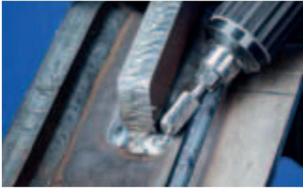
Walzenrundförmiger Frässtift nach DIN 8032 mit Verzahnung nach DIN 8033. Kombination zylindrischer und kugelförmiger Geometrien.
