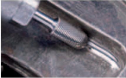
Walzenrundförmiger Frässtift nach DIN 8032. Kombination zylindrischer und kugelförmiger Geometrien.
