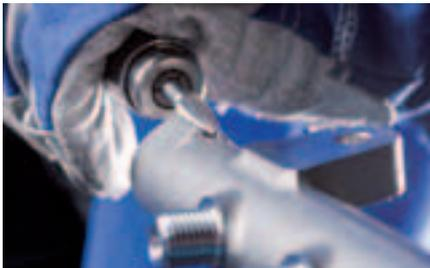
Rundbogenförmiger Frässtift nach DIN 8032.
