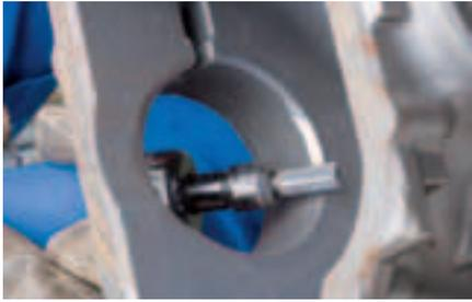
Zylindrischer Frässtift nach DIN 8032.
