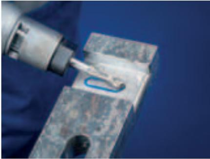
Frässtifte in vier Sonderformen mit Schaftdurchmesser 6 mm. Durch ihre unterschiedliche Formgebung bestens für verschiedenste Fräsarbeiten geeignet.
