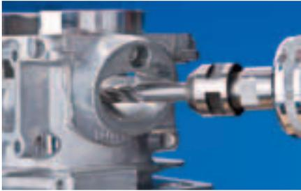
Zylindrischer Frässtift nach DIN 8032. Form ZYAS mit Verzahnung auf Umfang und Stirn.
