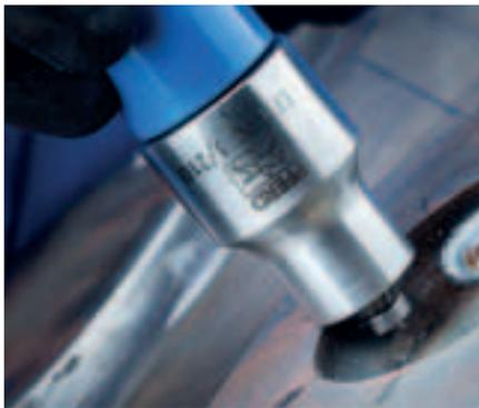
Kegelsenkförmiger Frässtift zum Erzeugen exakt definierter Fasen.
