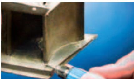
Kugelförmiger Frässtift nach DIN 8032 mit Verzahnung nach DIN 8033.
