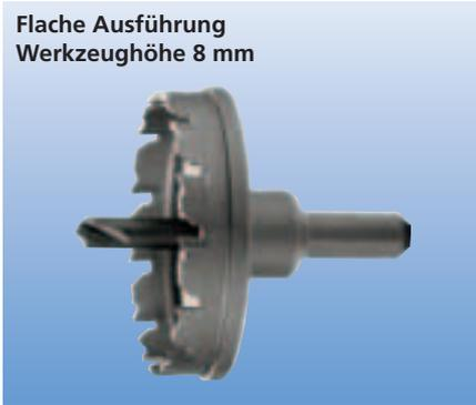
Die flache Ausführung (Werkzeughöhe 8 mm) ist für die Bearbeitung von Flachmaterial bis zu einer max. Materialdicke von 4 mm geeignet.
