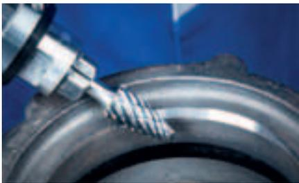
Rundbogenförmiger Frässtift nach DIN 8032.
