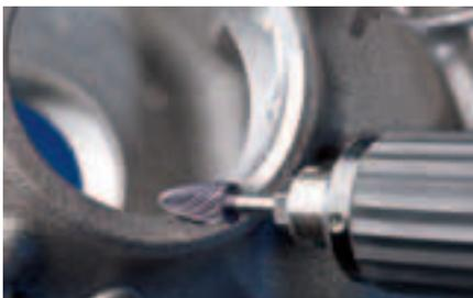
Rundbogenförmiger Frässtift nach DIN 8032 mit Verzahnung nach DIN 8033.
