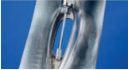
Walzenrundförmiger Frässtift nach DIN 8032 mit Verzahnung nach DIN 8033. Kombination zylindrischer und kugelförmiger Geometrien.
