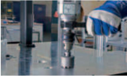
Die tiefe Ausführung (Werkzeughöhe 35 mm) ist für den Einsatz auf gewölbten Flächen und Rohrmaterialien geeignet. Die maximale Schnitttiefe beträgt 32 mm.
