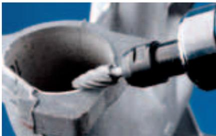
Rundbogenförmiger Frässtift nach DIN 8032.
