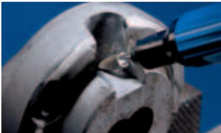
Rundbogenförmiger Frässtift nach DIN 8032.
