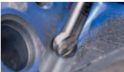
Kugelförmiger Frässtift nach DIN 8032.
