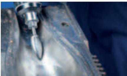
Flammenförmiger Frässtift nach ISO 7755/8 mit Verzahnung nach DIN 8033.
