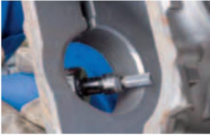
Zylindrischer Frässtift nach DIN 8032 mit Verzahnung nach DIN 8033. Form ZYAS mit Verzahnung auf Umfang und Stirn.
