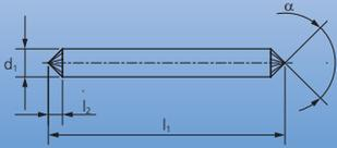
Kegelsenkförmiger Frässtift nach DIN 8032 mit Verzahnung nach DIN 8033 mit Winkel (90°). Die Ausführung KSK 0603/6 (Doppelender) ist beidseitig verzahnt und einsetzbar, siehe Abbildung.
