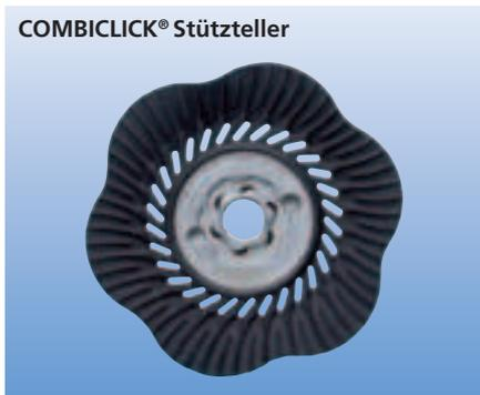
Mit diesem Stützteller können COMBICLICK® Werkzeuge auf handelsüblichen Winkelschleifern eingesetzt werden. Die Geometrie der Kühlschlitze sorgt für hohen Luftdurchsatz, wodurch die thermische Belastung des Schleifmittels und des Werkstückes deutlich reduziert wird.
