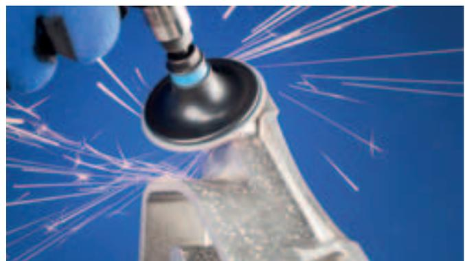
Hervorragend im Flächen- und Kantenschliff einsetzbar. Der Fiberrücken verstärkt das Schleifblatt und verbessert den Materialabtrag.
