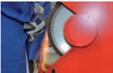
Für hohe Beanspruchung und maximalen Abtrag auf Stahl, Edelstahl (INOX), NE-Metallen und Gusseisen mit Lamellengraphit.
