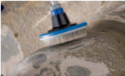
Zum Entfernen von weichen Materialien wie Klebstoff und Unterbodenschutz sowie zum Reinigen von Konturen und Kanten geeignet.
