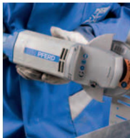
POLINOX®-Kompaktschleif-Discs werden im Stirnschliff auf drehzahlregelbaren Winkelschleifern eingesetzt. Sie eignen sich besonders zur Bearbeitung größerer Flächen an Bauteilen aus Edelstahl (INOX). Das verdichtete Vlies ist auf einem Glasgewebeteller verklebt.
