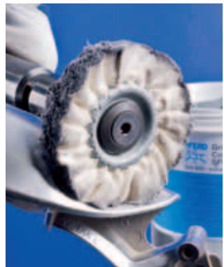
Öllösliche Schleifpasten mit scharfkantigem SiC-Korn werden bei Feinstschleifvorgängen eingesetzt, z. B. beim Einschleifen von Ventilsitzen, Wellenlagern und als Vorbereitung zum Polieren mit Filzpolierwerkzeugen und Tuchringen.
