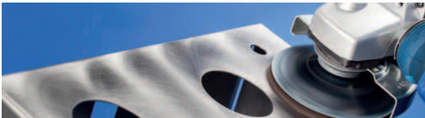
Zur Vor- und Hochglanzpolitur an mittleren bis großen Bauteilen bietet PFERD COMBICLICK® Filzronden in unterschiedlichen Durchmessern an.
