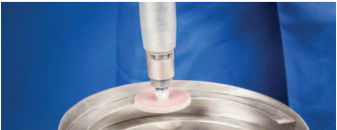
POLISTAR Schleifsterne sind flexible Werkzeuge, die speziell für die Bearbeitung der Innenflächen von Bohrungen und Rohren entwickelt wurden.
