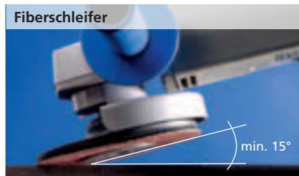
Mit COMBICLICK® werden Kratzer durch hervorstehende Spannteile vermieden und eine sehr hohe Ausnutzung des zur Verfügung stehenden Schleifmittels erzielt.
