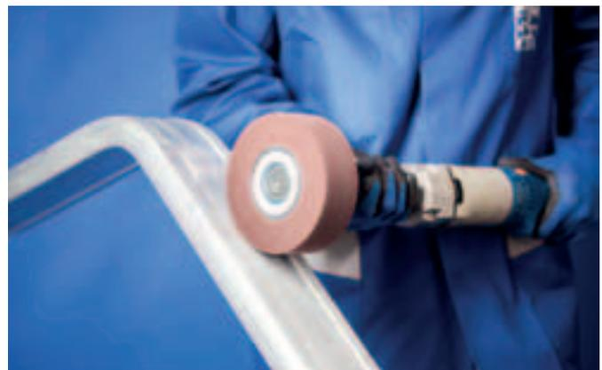
Zum Reinigen, Entgraten und Feinschleifen von Innenflächen und Konturen geeignet. Speziell für schwer zugängliche Stellen, z. B. Bohrungen und Vertiefungen, einsetzbar.
