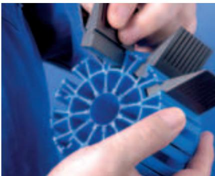
Die Gummilamellen, die zwischen den Schleiflamellen liegen, unterstützen den Schleifeffekt und die Flexibilität des Werkzeuges. Nach Abnutzung der Gummilamellen lassen sie sich mühelos am Schleifrad auswechseln.
