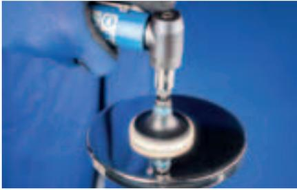
Zum Polieren mit Polierpasten-Riegeln, Schleifpasten oder Diamantpolierpasten im Stirnschliff an mittelgroßen Flächen geeignet.
