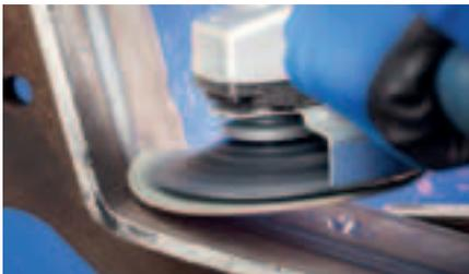
Weiches und besonders flexibles Schleifverhalten im Stirnschliff.
