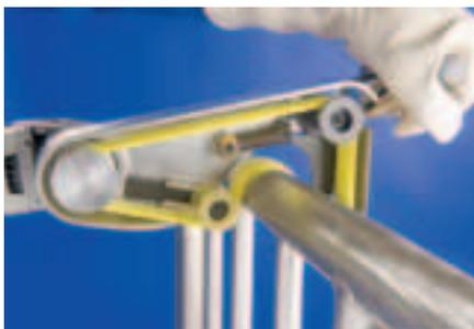
Werden mit Polierpasten zur Vor- und Hochglanzpolitur von Rohrkonstruktionen und Geländern eingesetzt.
