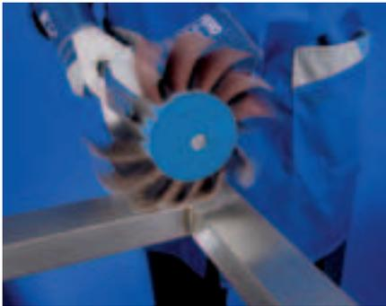
Zur Erzielung optischer Effekte stehen acht verschiedene Korngrößen zur Verfügung. Nach Abnutzung der Schleiflamellen lassen sie sich mühelos am Schleifrad auswechseln.
