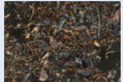
Späne erzeugt mit konventionellen Schrupp- oder Fächerschleifscheiben. Blaufärbung durch Überhitzung.
