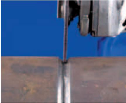
Hartes Profi-Werkzeug in Härte R mit hoher Schleiffreudigkeit und sehr guter Standzeit. Für Einsätze unter hoher Belastung. Besonders formstabil für Einsätze im Pipelinebau.
