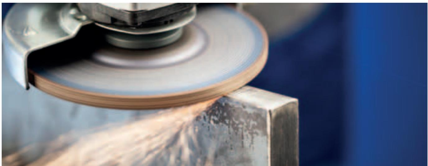
Sehr weiches Spezialwerkzeug in Härte H mit außergewöhnlich hoher Schleiffreudigkeit. Auch auf weichem, schmierendem Aluminium setzt sich das Werkzeug nicht zu.
