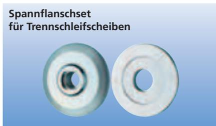
Spezialflansch in  $\varnothing$  76 mm für Antriebsspindeln M14 bzw. 5/8" aus Werkzeugstahl. Zur Erhöhung der Seitenstabilität und Verbesserung der Kraftübertragung bei Trennschleifscheiben.
