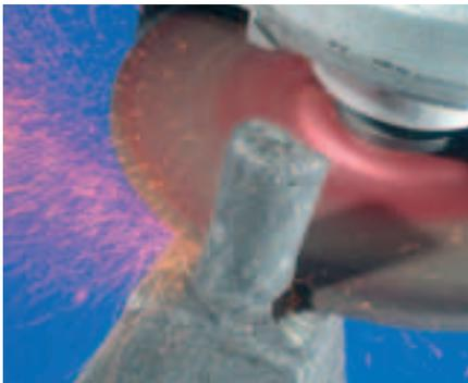
Sehr hartes Hochleistungswerkzeug in Härte T mit herausragender Schleiffreudigkeit und Standzeit.
