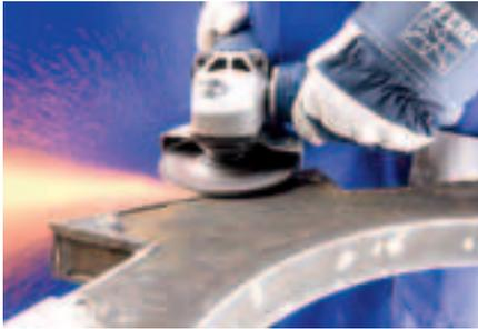
Ausführung STEEL für ultimative Abtragsleistung auf Stahl.
