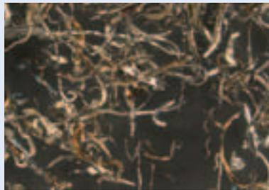
Lange Späne erzeugt mit der POLIFAN®-STRONG-FREEZE. Keine Blaufärbung aufgrund geringer thermischer Belastung.
