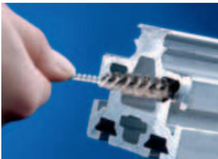
Speziell für Bürstarbeiten an schwer zugänglichen Stellen wie Innenflächen von Rohren und Bohrungen im Handeinsatz geeignet.
