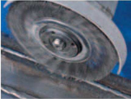
Aggressiv arbeitende Bürste. Für schwere Bürstarbeiten im Metallbau wie Entzundern, Entrosten, Entgraten, Putzen von Schweißnähten und Entfernen von Kleberresten geeignet.
