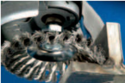
Aggressiv arbeitende Bürste. Hervorragend für schwere Bürstarbeiten wie Entgraten, Reinigen und Entrostern geeignet. Aufgrund der Kegelform optimal an schwer zugänglichen Stellen wie Innenkanten, Rillen und Nuten einsetzbar.
