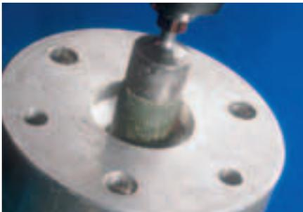
Für mittelschwere Bürstarbeiten geeignet. Punktgenaues Arbeiten aufgrund in Kunststoff eingegossener Drähte möglich. Besonders in Vertiefungen und Bohrungen einsetzbar.
