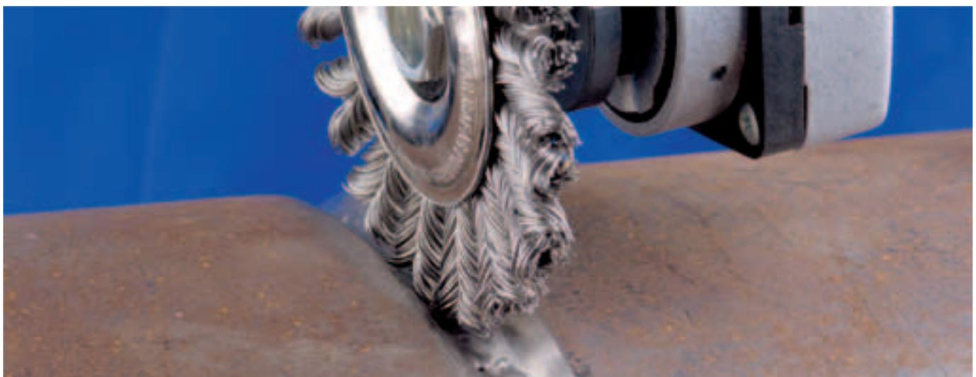
Aggressive und stabile Bürste, die hoher mechanischer Belastung standhält. Für alle schweren Bürstarbeiten im stationären und automatisierten Einsatz, z. B. Entgratarbeiten, geeignet.
