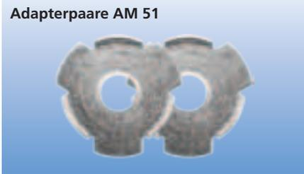
Mit dem Adapterpaar AM 51 sind Rundbürsten in den Ausführungen breit und mit Plastikkörper ab einem Bürsten- $\varnothing$  von 150 mm auf allen gängigen Werkzeugantrieben einsetzbar. Ein Set besteht aus 2 Einzeladaptern.
