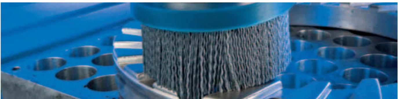
Hervorragend für die Oberflächenstrukturierung großflächiger Werkstücke geeignet.
