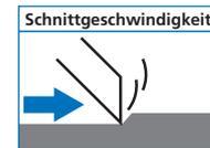
Die Schnittgeschwindigkeit ist die Geschwindigkeit, mit der eine Werkzeugschneide in Schnittrichtung durch den zu bearbeitenden
