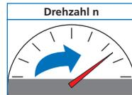
Die Drehzahl  $n$  wird in Umdrehungen pro Minute [ $\text{min}^{-1}$ ] angegeben. Die benötigte Drehzahl wird ermittelt aus der Schnittgeschwindigkeit  $V$  in Meter pro Minute [ $\text{m}/\text{min}$ ] oder in Meter pro Sekunde [ $\text{m}/\text{s}$ ] und dem Durchmesser des Werkzeuges  $d \times \pi$  (3,14).
